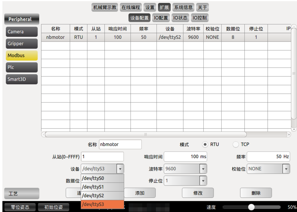
图 10-59 Modbus 设备配置
