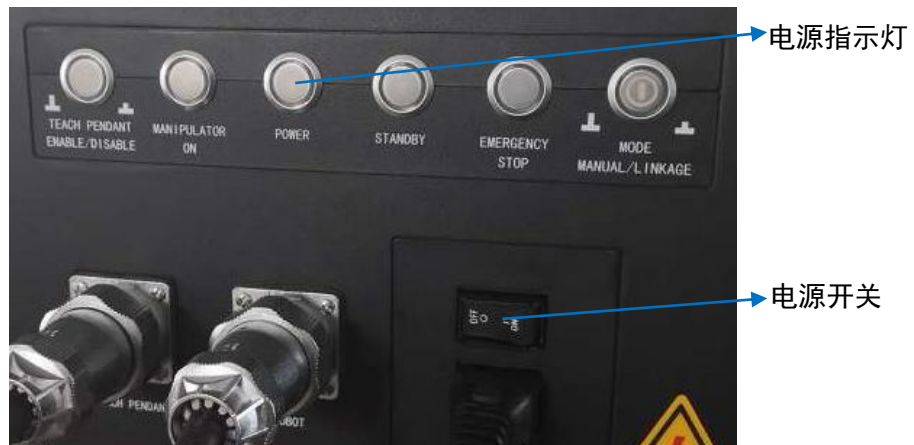
图 9-1 控制柜电源开关及指示灯示意图
