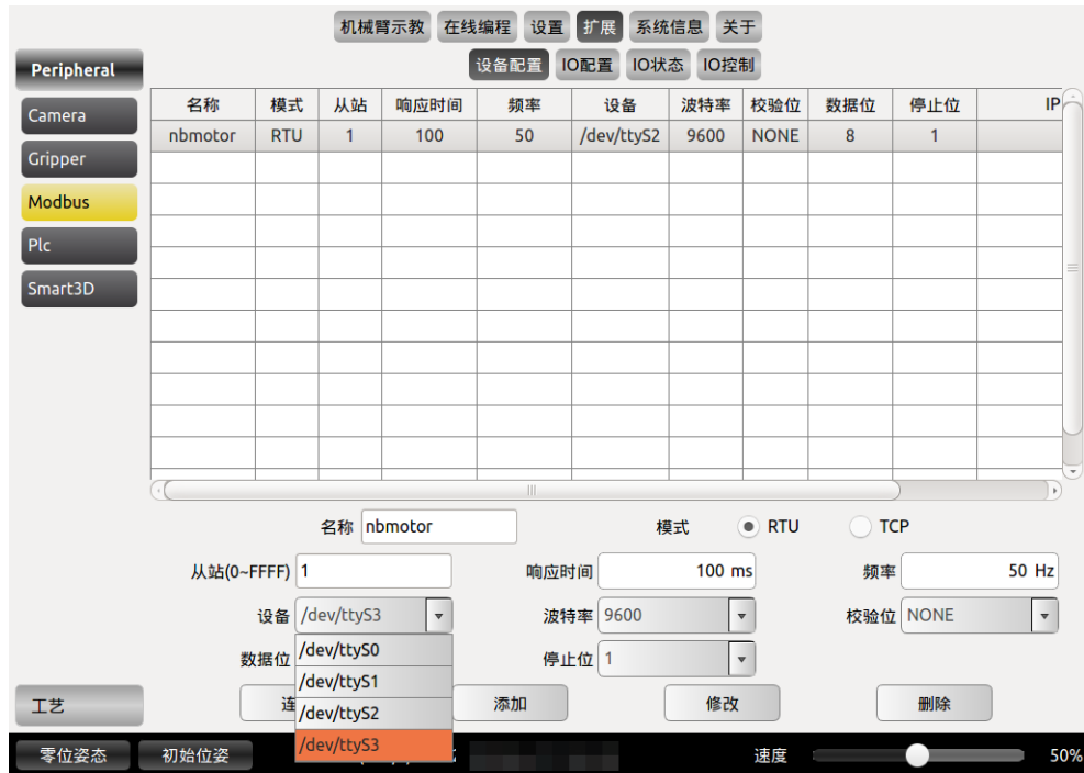
图 10-59 Modbus 设备配置
