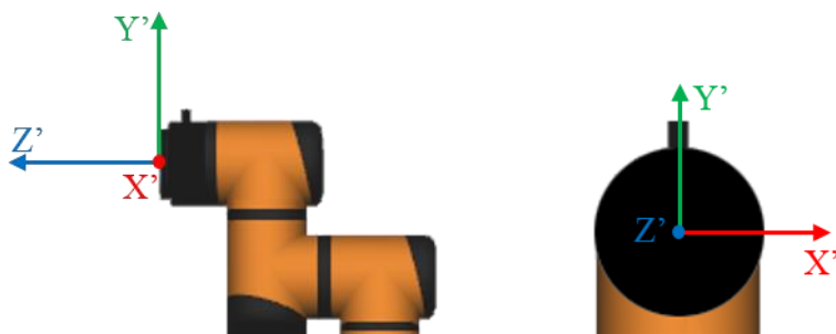
图 10-12 末端坐标系(end)
