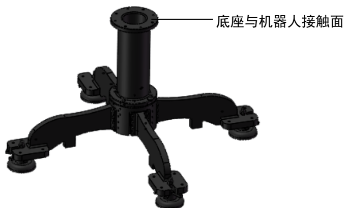
图 6-3 底座结构示意图
