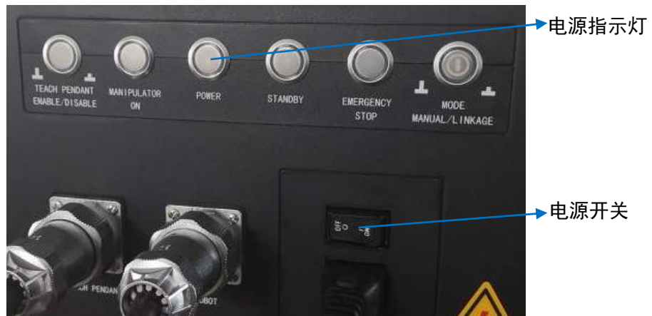
图 9-1 控制柜电源开关及指示灯示意图
