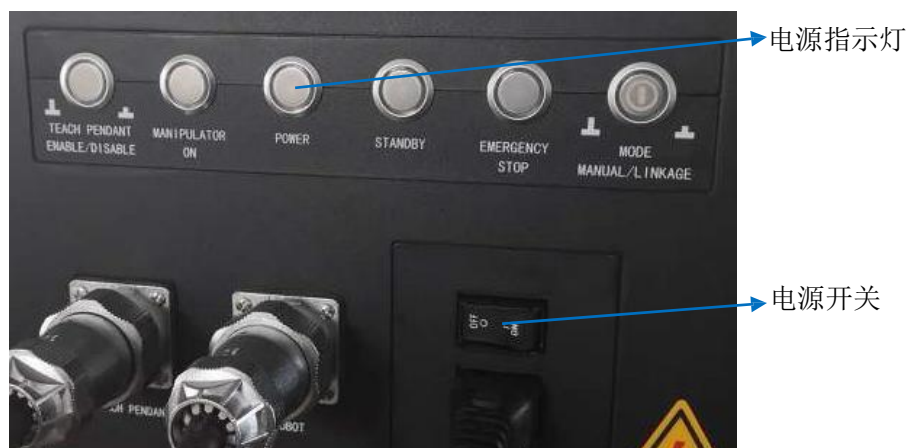
图 9-1 控制柜电源开关及指示灯示意图
