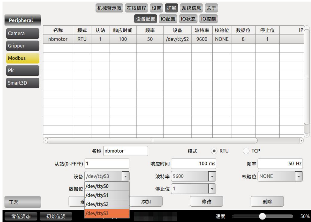
图 10-56 Modbus 设备配置
