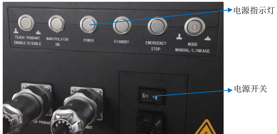
图 9-1 控制柜电源开关及指示灯示意图
