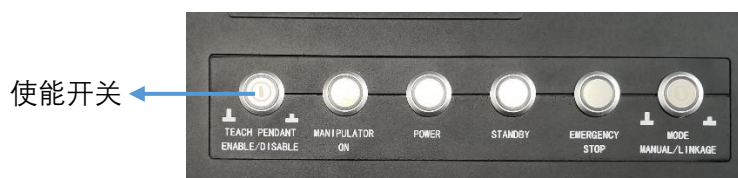
图 7-6 示教器使能开关位置
