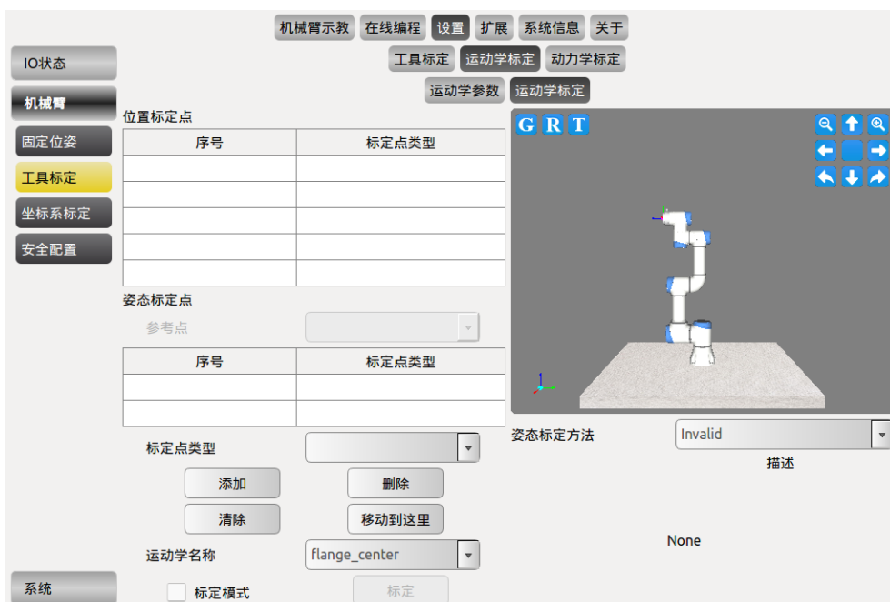
图 10-28 运动学工具标定
