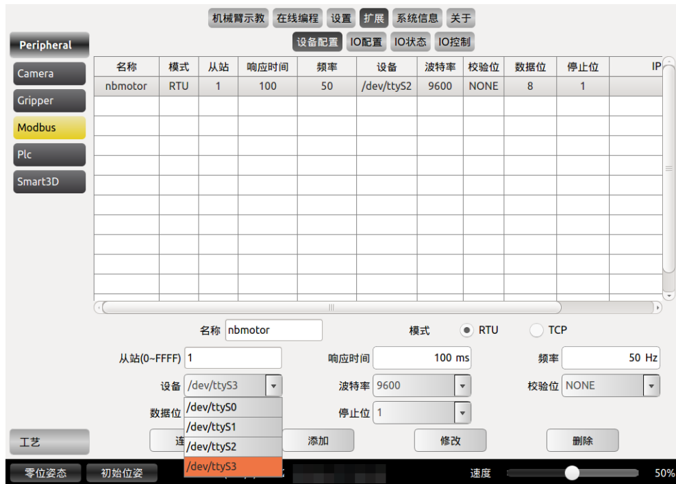
图 10-59 Modbus 设备配置
