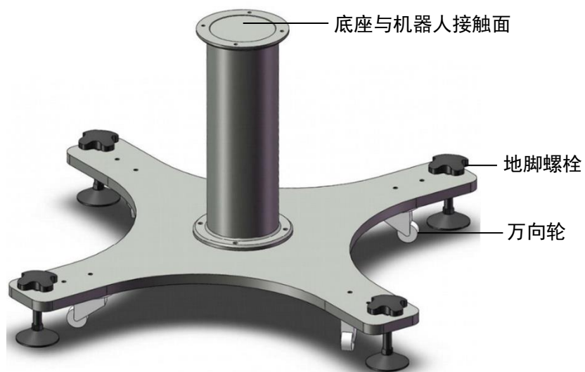
图 6-3 底座结构示意图
