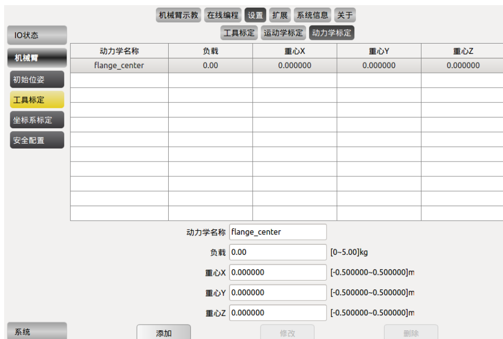
图 10-36 工具动力学标定
