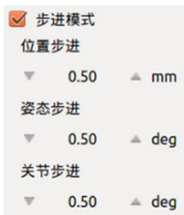
图 10-8 步进模式示意图
