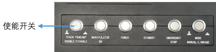
图 7-6 示教器使能开关位置
