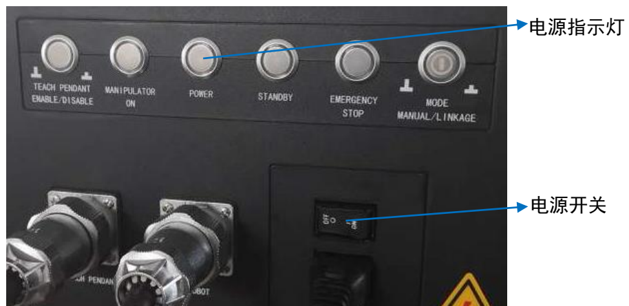
图 9-1 控制柜电源开关及指示灯示意图
