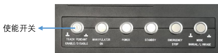
图 7-8 示教器使能开关位置
