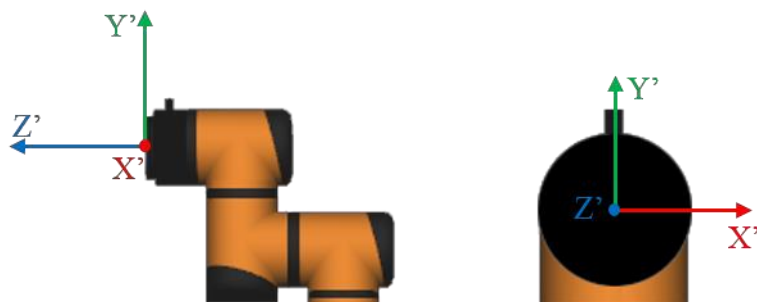
图 10-12 末端坐标系(end)
