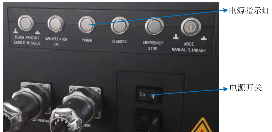
图 9-1 控制柜电源开关及指示灯示意图
