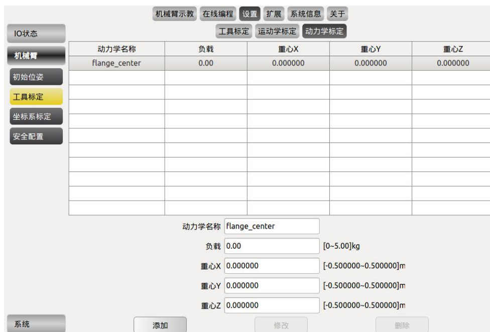
图 10-35 工具动力学标定
