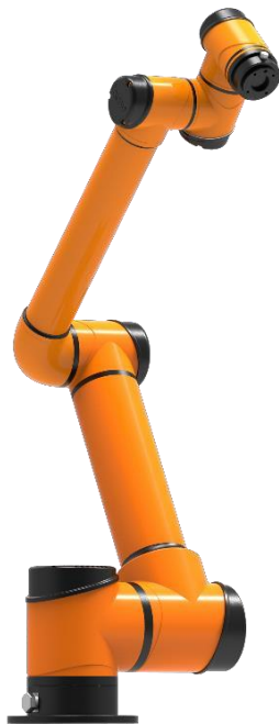
AUBO-i7 本体外形结构示意图
