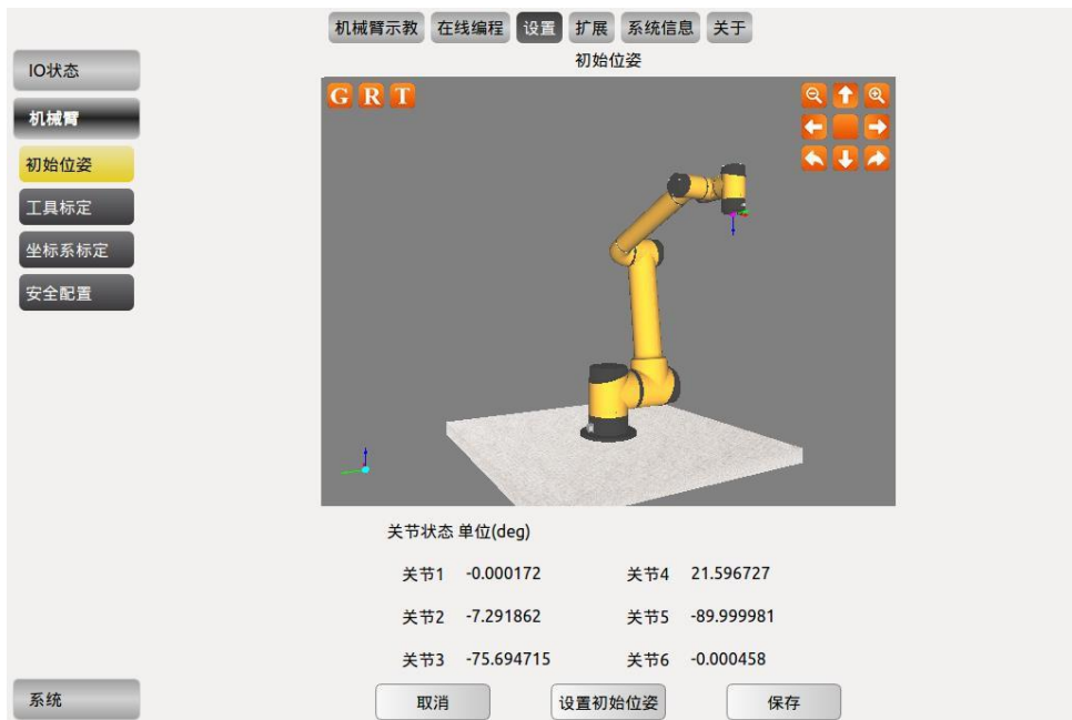
图 10-26 机器人初始位姿设置
