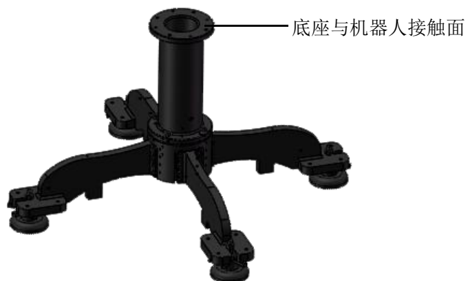
图 6-3 底座结构示意图
