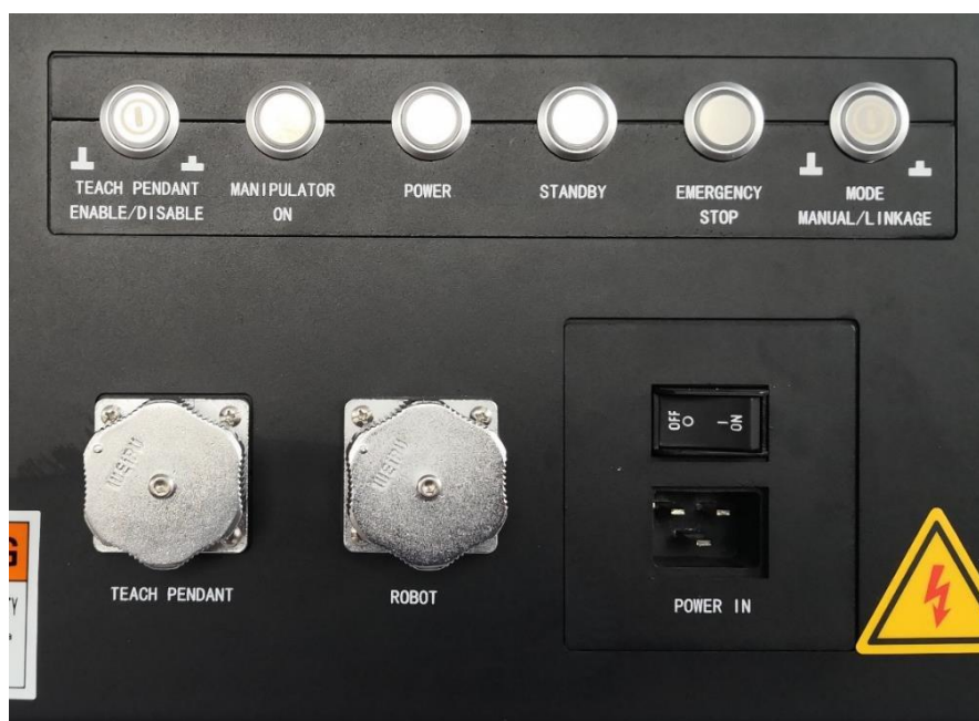
图 7-2 控制柜前面板示意图
