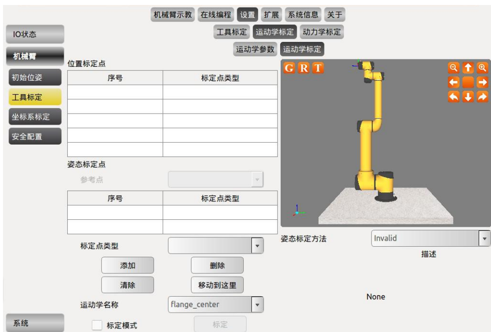
图 10-27 运动学工具标定
