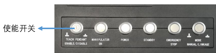
图 7-8 示教器使能开关位置
