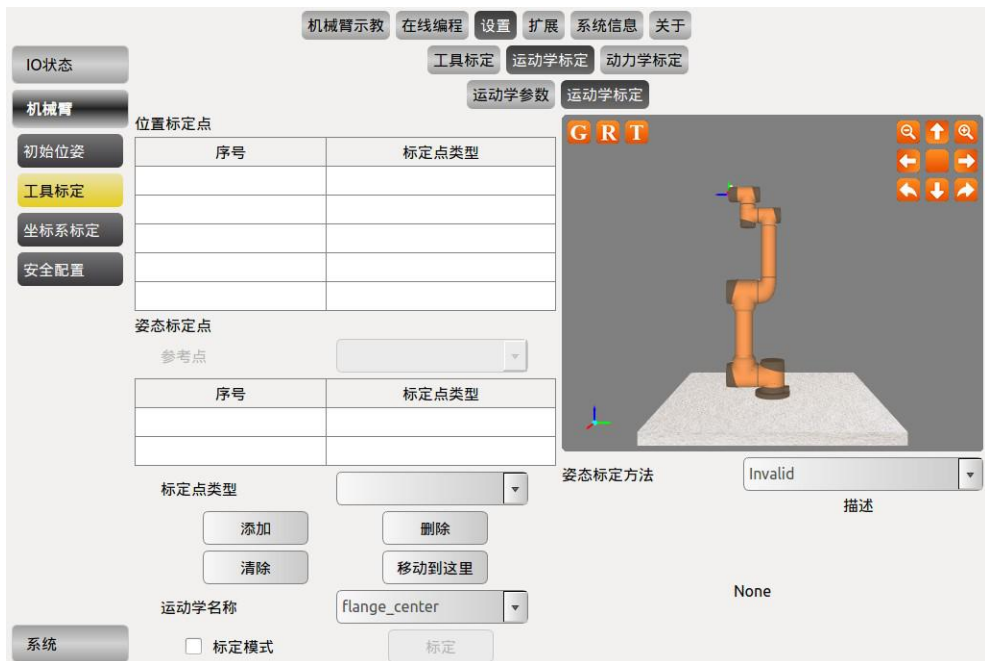
图 10-27 运动学工具标定
