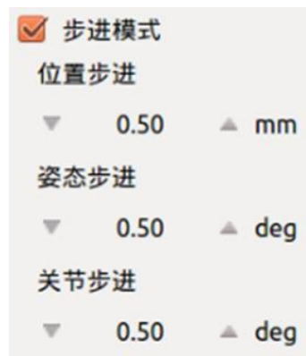
图 10-8 步进模式示意图
