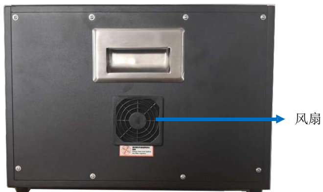
图 7-3 控制柜侧面板
