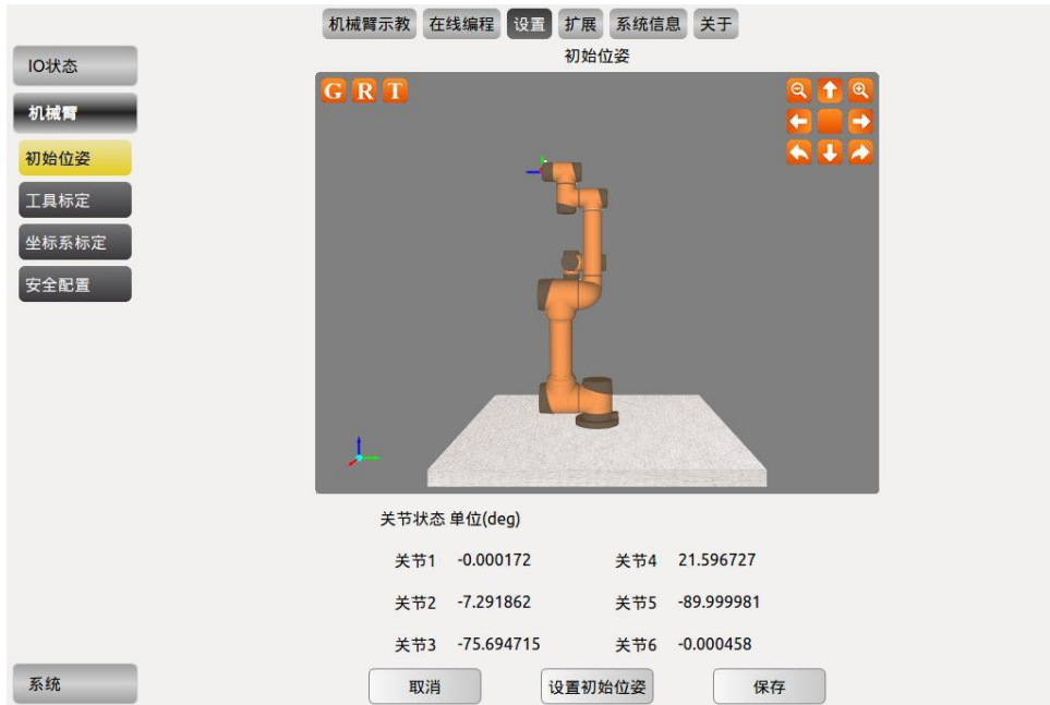
图 10-26 机器人初始位姿设置
