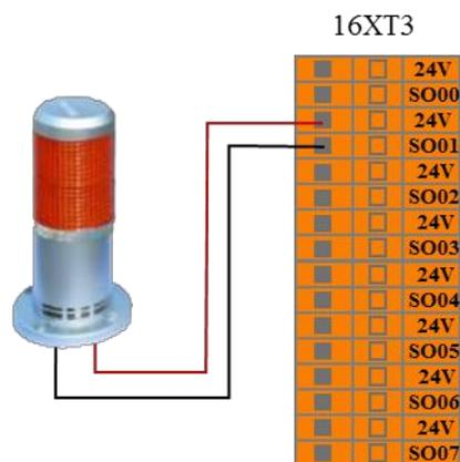
图 8-15 机器人运动输出连接示意图
