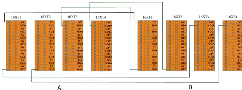
图 8-13 系统停止输入连接示意图
