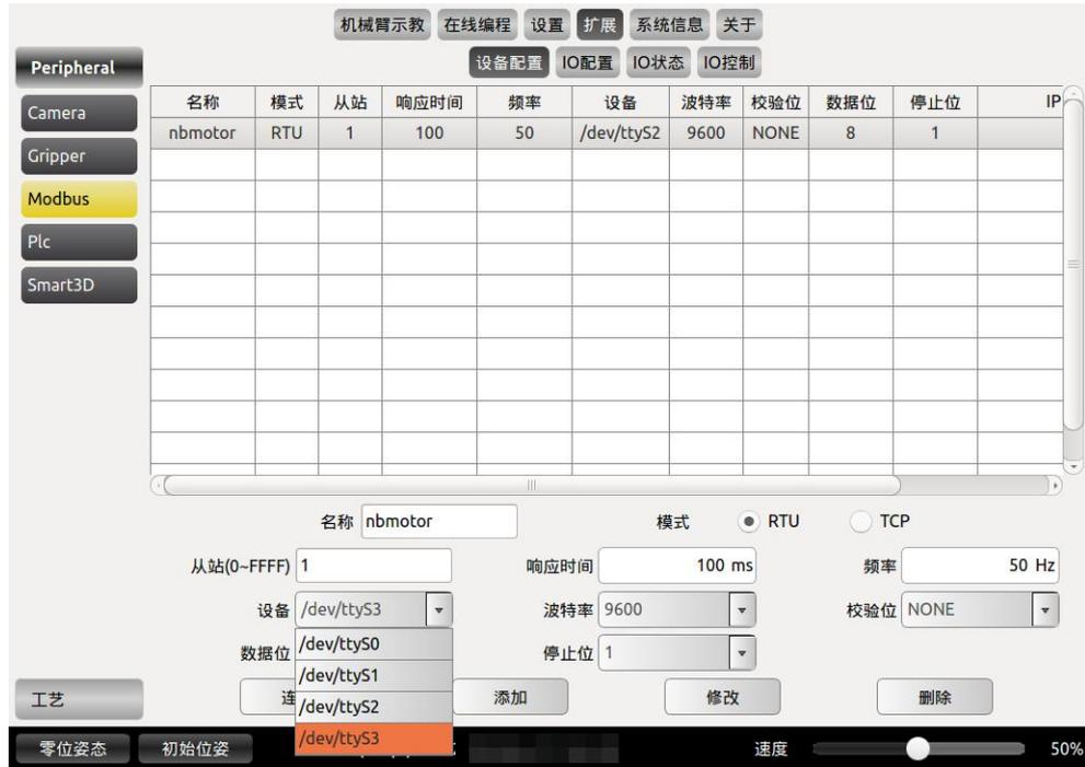
图 10-56 Modbus 设备配置
