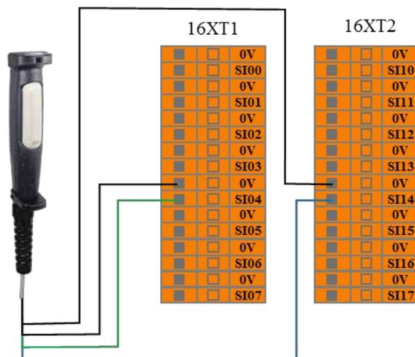
图 8-10 三态开关输入连接示意图
