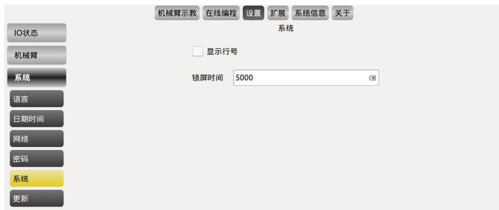
图 10-52 锁屏时间 勾选显示行号，切换至在线编程界面后，在程序逻辑处将显示程序的行号。输入锁屏时间，点击确认，可更新屏幕锁定的时间。
