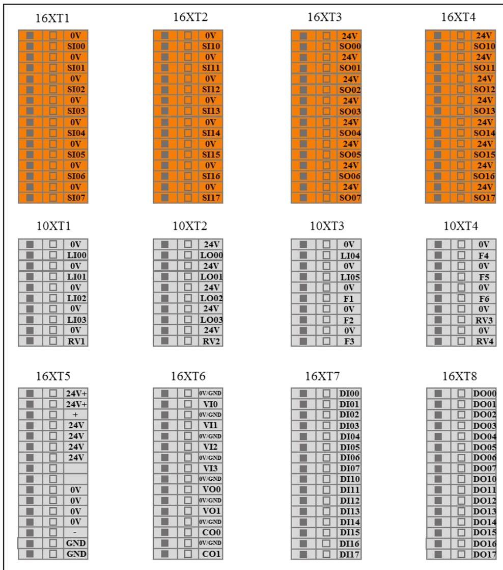
图 7-5 控制柜外部电气接口放大示意图
