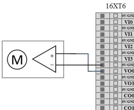
图 8-28 电压模拟输出连接驱动设备
