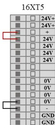
图 8-2 内部电源供电示意图
