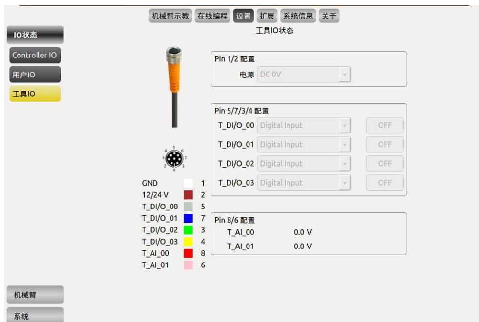
图 10-25 工具端 I/O 设置
