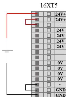
图 8-3 外部电源供电示意图
