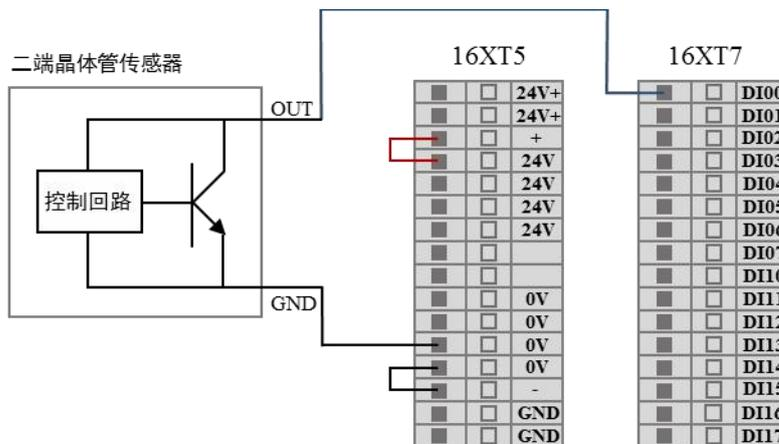
图 8-24 DI端连接二端传感器示意图
