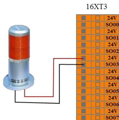
图 8-17 缩减模式输出连接示意图
