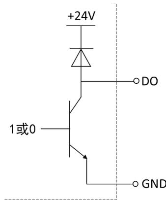
图 8-22 DO 端 NPN 工作方式示意图
