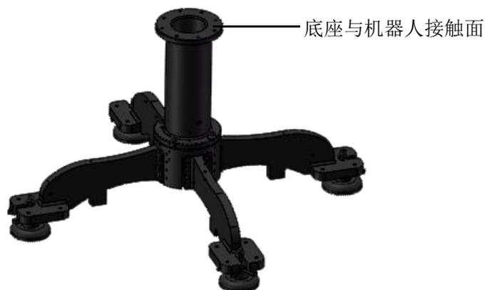
图 6-3 底座结构示意图
