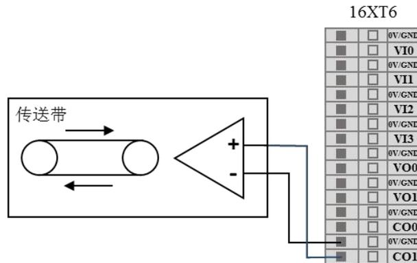
图 8-29 电流模拟输出连接电流源
