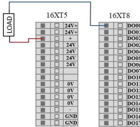
图 8-25 DO 端接负载示意图
