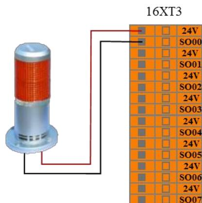
图 8-14 系统紧急停止输出连接示意图
