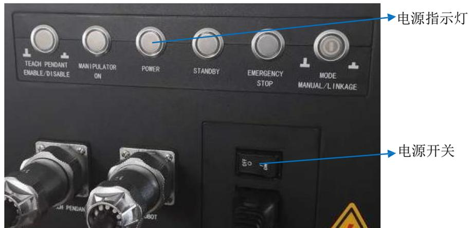
图 9-1 控制柜电源开关及指示灯示意图
