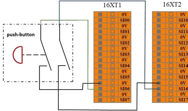
图 8-12 拖动示教输入连接示意图
