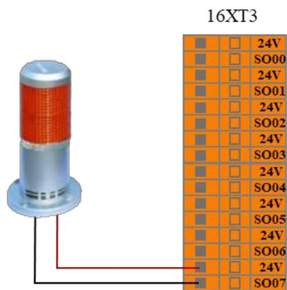
图 8-21 上位机运行指示输出连接模式
