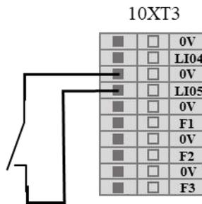
图 8-32 远程关机接线示意图
