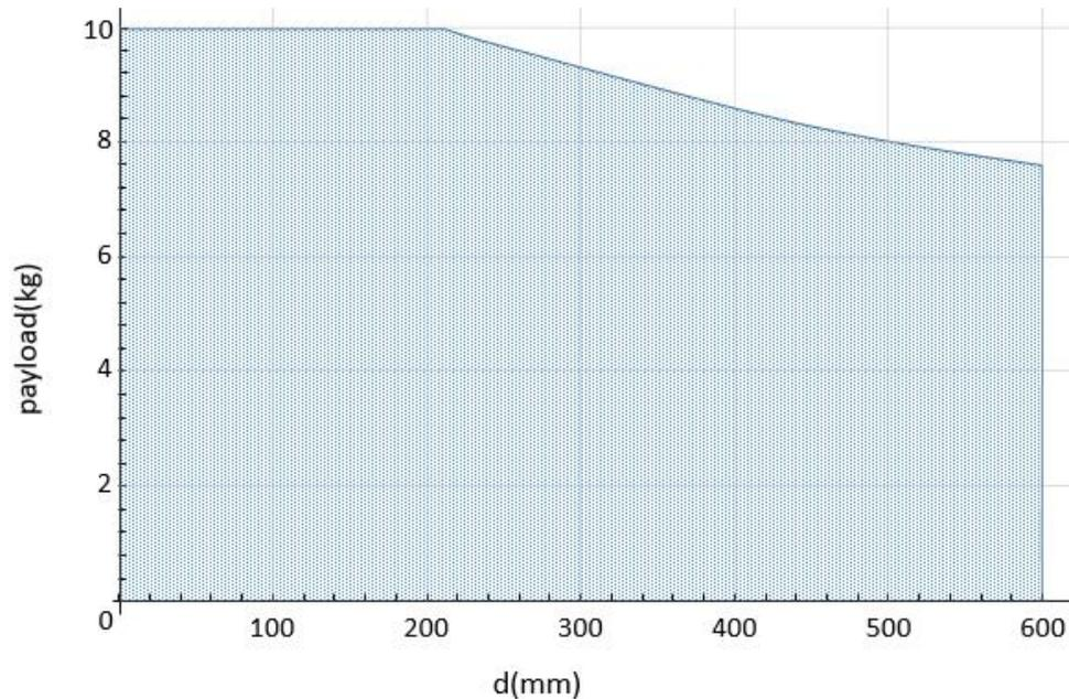
上图所示为腕部有效负载图，其中横坐标 d 分别表示重心偏移量，重心偏移量为工具末端法兰盘中心到工具重心之间的距离。
