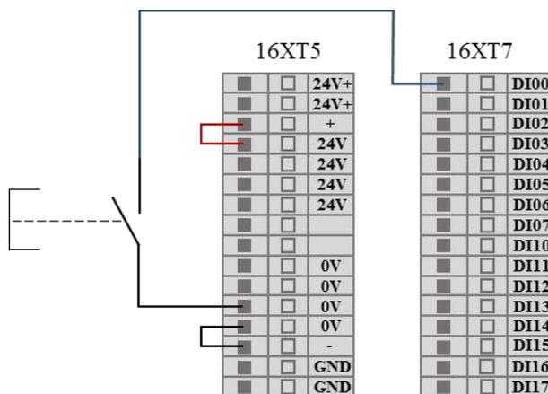
图 8-23 DI端连接按钮开关示意图
