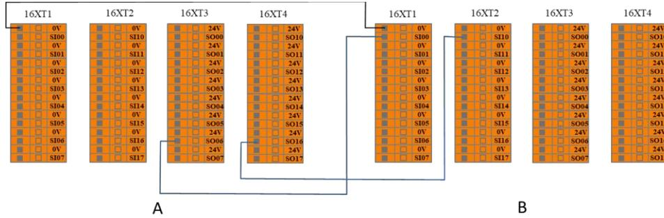
图 8-20 多台机械臂共享紧急停止连接模式
