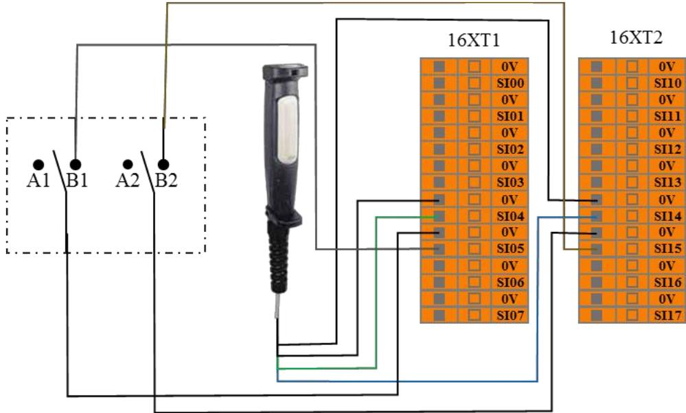
图 8-11 操作模式输入连接示意图
