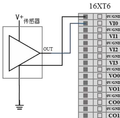
图 8-27 模拟电压输入连接传感器
