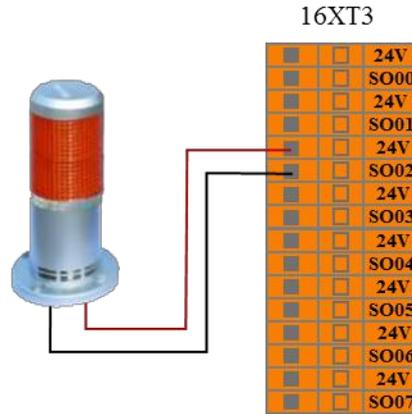
图 8-16 机器人未停止输出连接示意图
