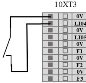
图 8-31 远程开机接线示意图
