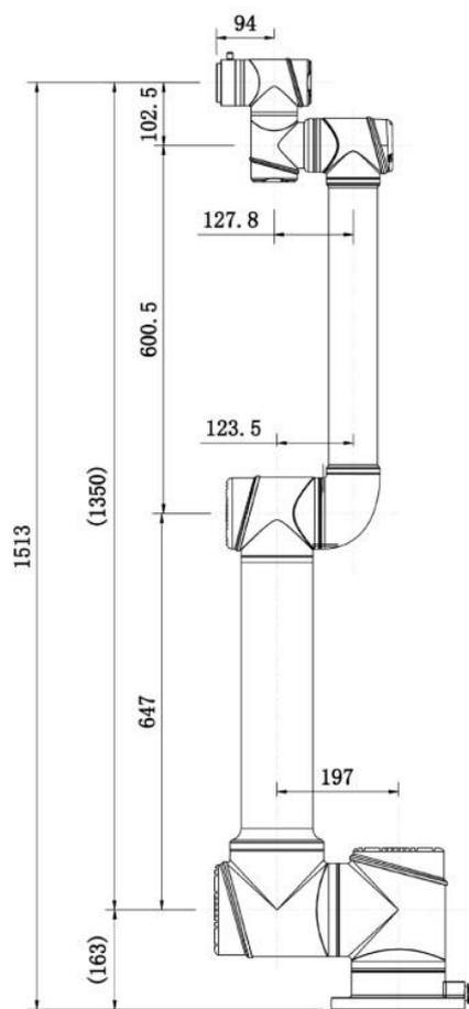
图 6-1AUBO-i10 机器人机械尺寸图 (单位: mm)
