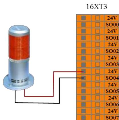
图 8-18 非缩减模式输出连接示意图
