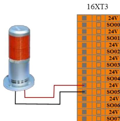
图 8-19 系统错误输出连接模式
