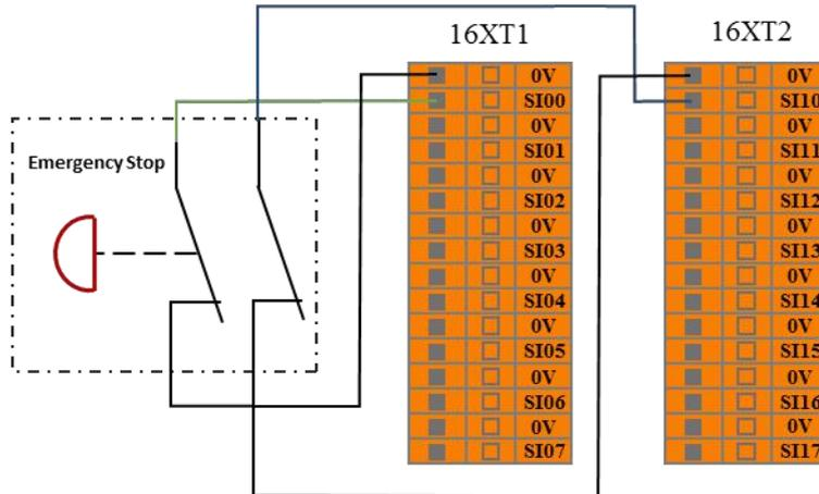
图 8-5 外部紧急停止输入连接示意图
