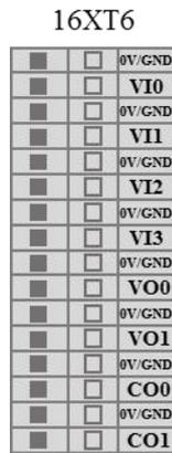
图 8-26 模拟 I/O 接口示意图
