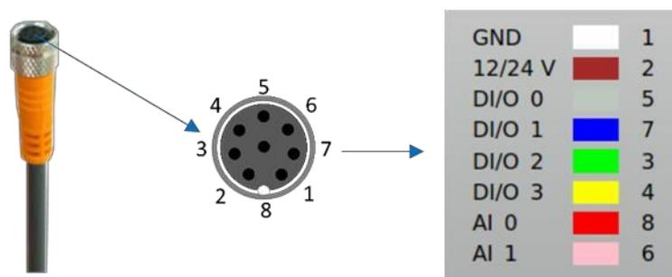
图 8-34 机器人本体工具 I/O 接口示意图
