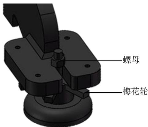
图 6-4 底座地脚结构示意图
