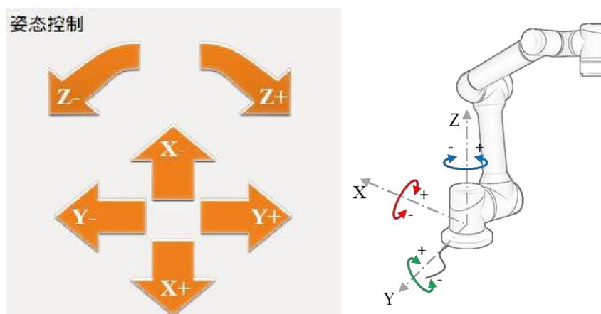
图 10-15 姿态控制示意图 (base)
