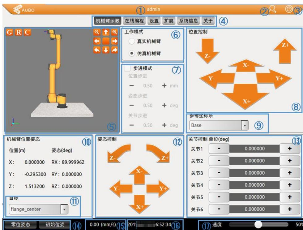
图 10-4 机器人示教面板示意图
