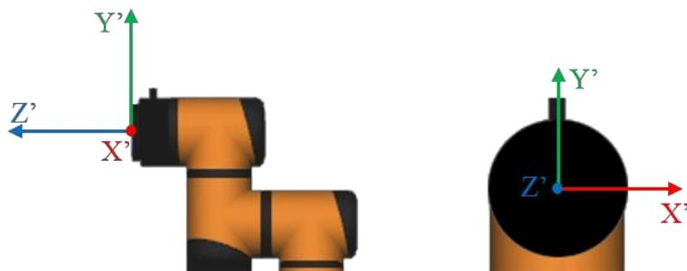
图 10-12 末端坐标系(end)
