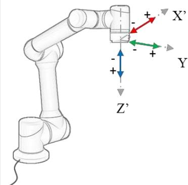
图 10-10 位置控制示意图 (end)
